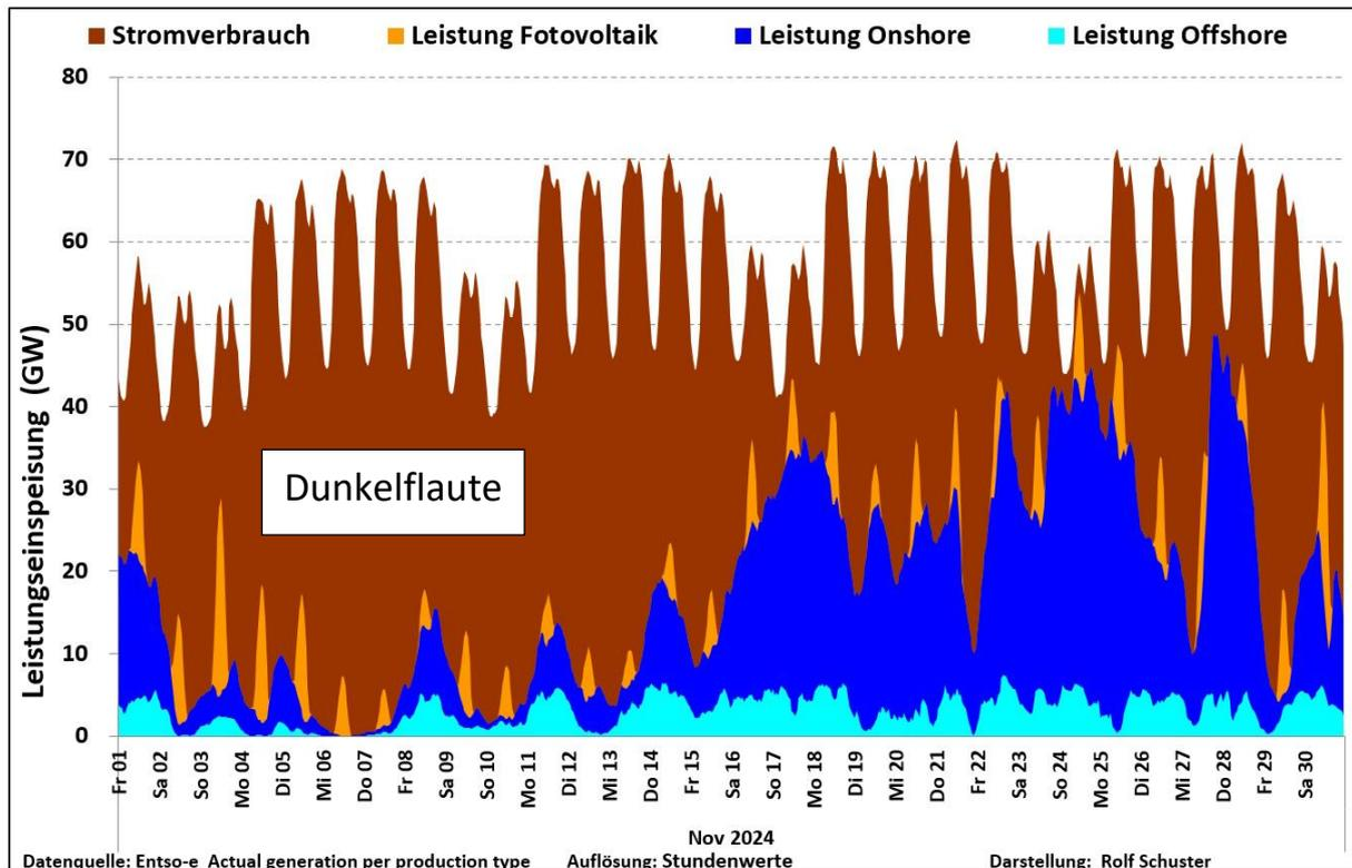
Die Konturen der blauen und gelben Flächen für Wind und Sonne (vergleiche **Abb. 1** und **Abb. 2**) dokumentieren den zeitlichen Verlauf der gesamten Leistungseinspeisungen aller deutschen Windkraft- und Photovoltaik-Anlagen im Berichtszeitraum.
