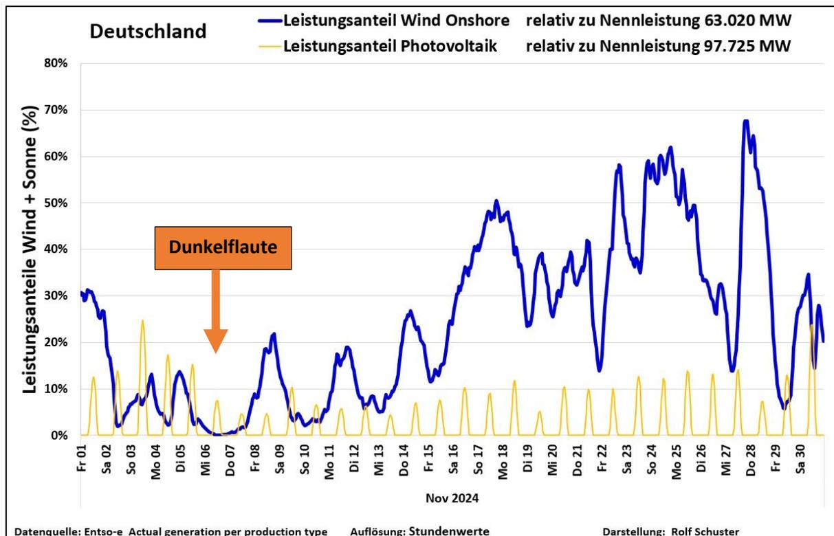
Nachstehend eine Übersicht der Ausnutzung der installierten Nennleistungen aller **Windenergie-Anlagen** im **November 2024** in Stunden und Prozent der Monatszeit für verschiedene Leistungsstufen.
