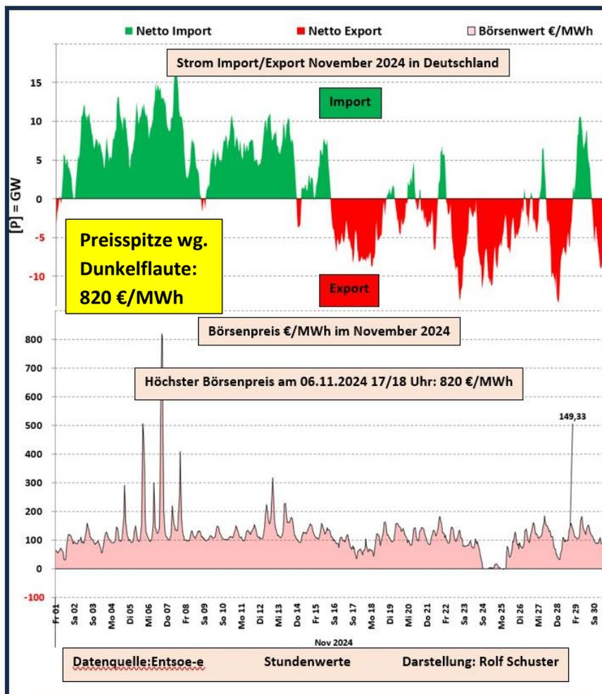
Durch den völligen Ausfall der Windenergie und Photovoltaik am 6.11.2024 musste am 06.11.2024 zwischen 17/18 Uhr an der Börse ein Höchstpreis von 82 Cent/kWh bezahlt werden: Leistungsdefizit in Deutschland mit hohem Stromimport aus dem europäischen Ausland bis 16.000 MW.
