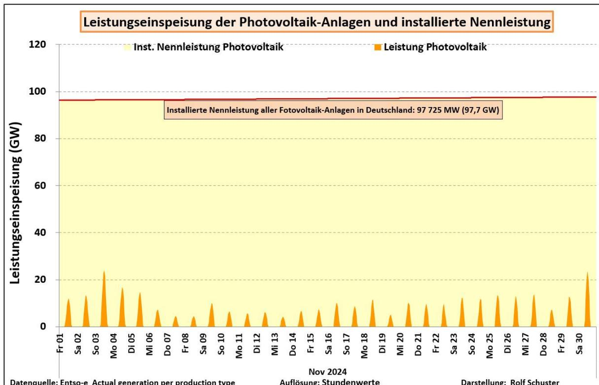
In **Abb. 2** wird die Leistungsganglinie aller deutschen Photovoltaik-Anlagen vor dem Hintergrund der installierten Nennleistung dieser Anlagen mit aktuell **97.725 MW (97,7 GW)** im Berichtsmonat November 2024 dokumentiert. Nach gängiger Faustformel entspricht diese Nennleistung einer Kollektorfläche von ca. 600 Millionen m<sup>2</sup> (600 km<sup>2</sup> oder anschaulich 85.000 Fußballplätze).
